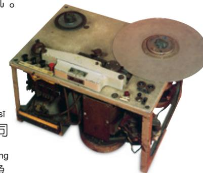
磁带录音机替代了老式的钢丝
